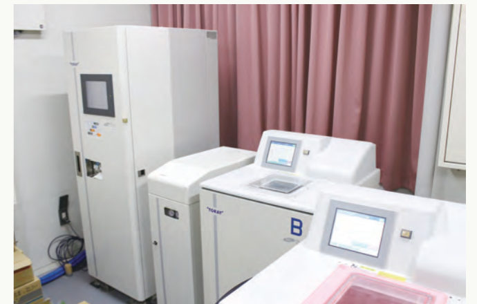
▲写真3 粉末剤自動溶解装置 多人数用透析液供給装置
